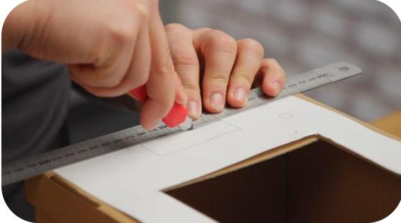
Nun fehlen noch Aussparungen im Schuhkarton-Deckel. Lege dazu den Schuhkarton vor dich und achte darauf, dass er sich „nach links“ öffnen lässt. Nimm die Schnittvorlage und lege diese mittig und bündig mit der unteren Kante auf den geschlossenen Schuhkarton. Nun kannst du die Ausschnitte für das Display, die Knöpfe und das Papier ausschneiden.
