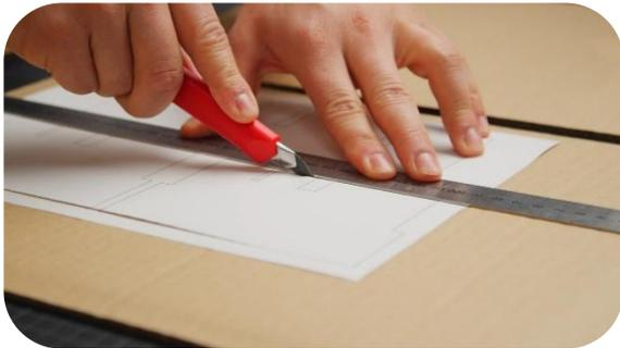
Nutze die Vorlagen, um die Formen aus den Pappbögen herauszuschneiden. Du kannst sie entweder mit einer Schere aus dem Papier ausschneiden und dann mit einem Bleistift auf die Pappbögen übertragen. Oder du legst die Vorlage direkt auf den Pappbogen und schneidest mit einem Cutter-Messer entlang der Linien durch Papier und Pappbogen.
